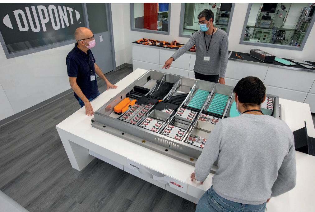
Bei den Batterien von Elektrofahrzeugen spielen Thermoplaste eine wichtige Rolle. Sie helfen etwa die Temperatur im optimalen Bereich zu halten für eine lange Lebensdauer und hohe Leistung der Batterien. © DuPont
